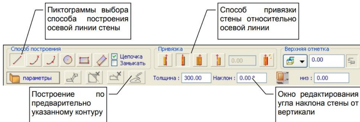
Рис. 3.3 Вызов инструмента Стена и его панель свойств
