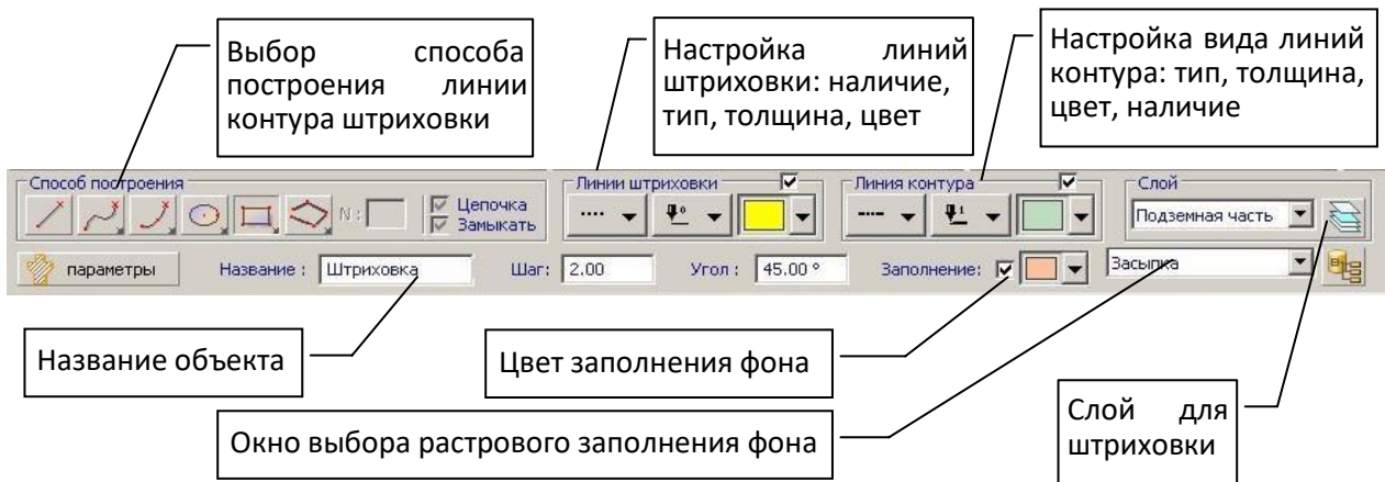
Рис. 3.21 Панель свойств инструмента Штриховка
