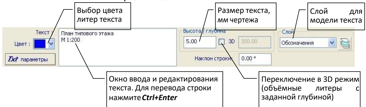
Рис. 3.18 Панель свойств инструмента Текст
