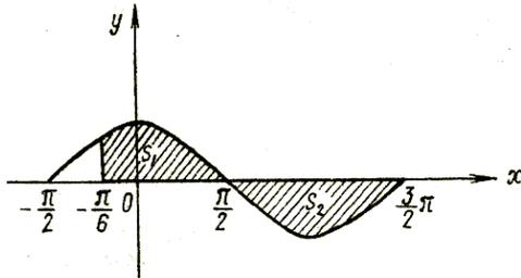
На чертеже видно, что фигура, ограниченная заданными линиями, состоит из двух криволинейных трапеций, одна из которых находится над, а другая под осью абсцисс.
