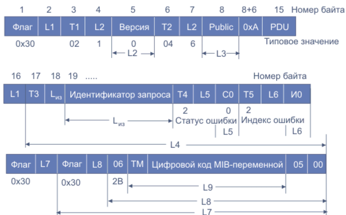
Рис. 4 - Формат заголовка SNMP-запроса
