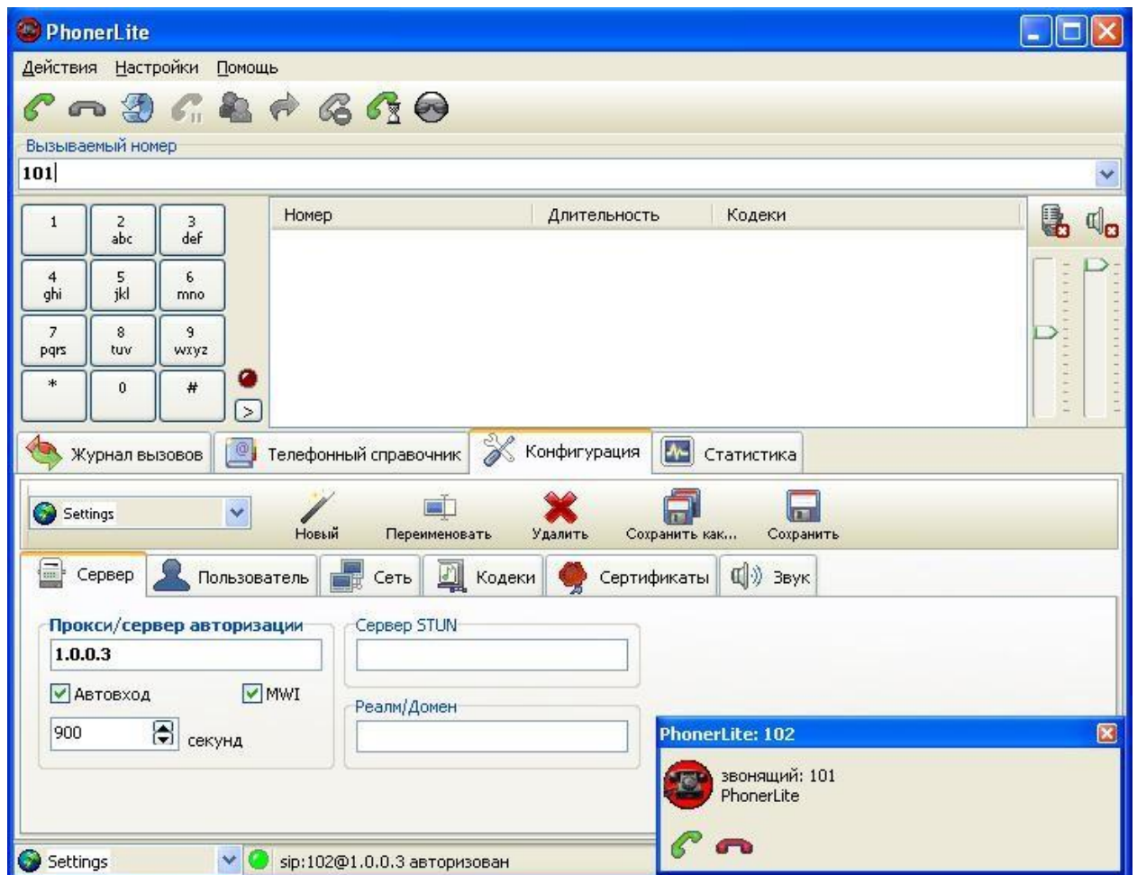
Рисунок 3.3.7 – Окно программы PhonerLite для АТС2 с входящим вызовом
