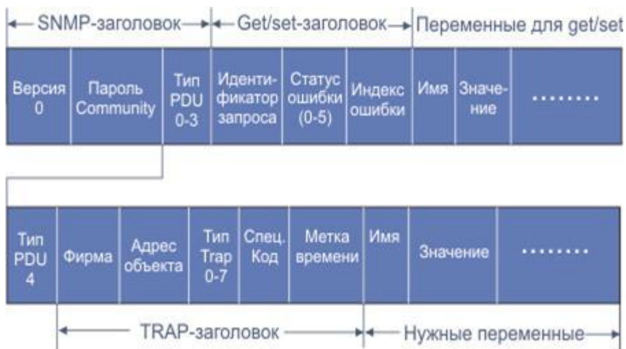
Рис. 3 - Формат SNMP-сообщений, вкладываемых в UDP-дейтограммы
