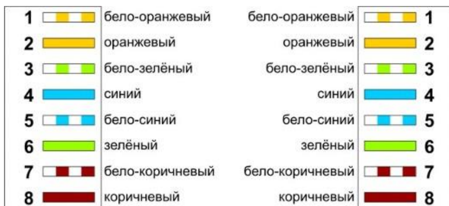
Рис. 2. Прямой обжим для соединения ПК-ХАБ (Одинаковый цвет проводников с обеих сторон кабеля)
