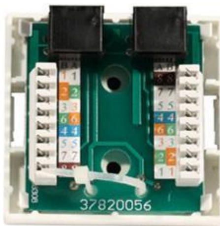
Рис. 12. Цветовая маркировка проводов розетки стандарта T568B это: 1 бело-ор, 2 ор, 3 бело-зел, 4 син, 5 бело-син 6 зел 7 бело кор, 8 кор (для варианта T568A цвета тоже нарисованы)
