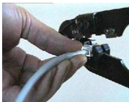
Рис. 5. Коннектор вставлен в кримпер
