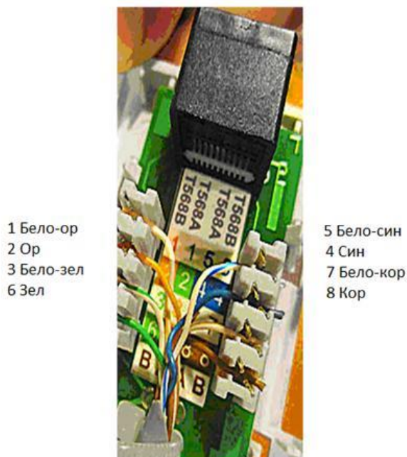
Рис. 10. Нумерация контактов в розетке с одним гнездом по стандарту T568B (для стандарта T568A цвета контактов розетки тоже обозначены)
